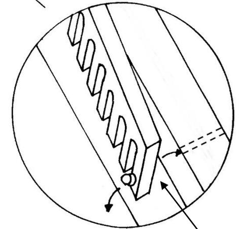
Schwarze Kunststoff-Unterlegscheibe zwischen T-Träger und Zahnstange anbringen
